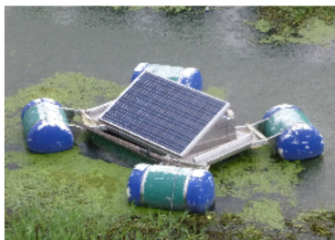
瀬田に設置しているナノバブルフロート
