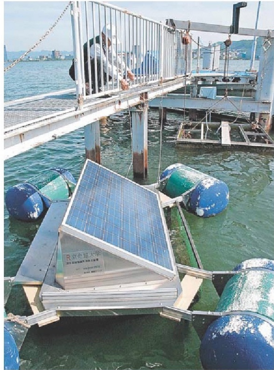
姥田川での実験に用いる装置。太陽光パネルの下に気泡発生装置があり、スクリューで水中に送り込む(大津市柳が崎)
