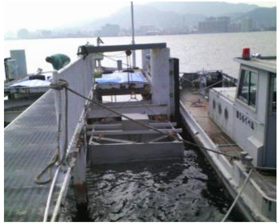
中央部分が 2.2m角 x 深さ 4.6mの閉水槽枠で底面はヘドロ層に 0.3m 食い込んでい
