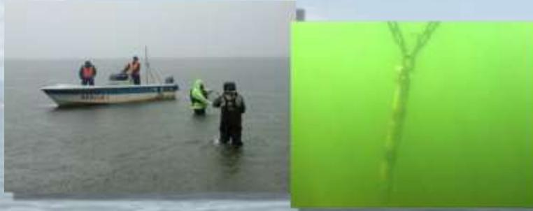
※サーミスタとは、温度の変化により、抵抗値が変化する電子部品のことである。温度が下がると抵抗値が上がることを利用して温度の測定に用いられる。湖沼等での自動観測に昔から広く用いられている。
